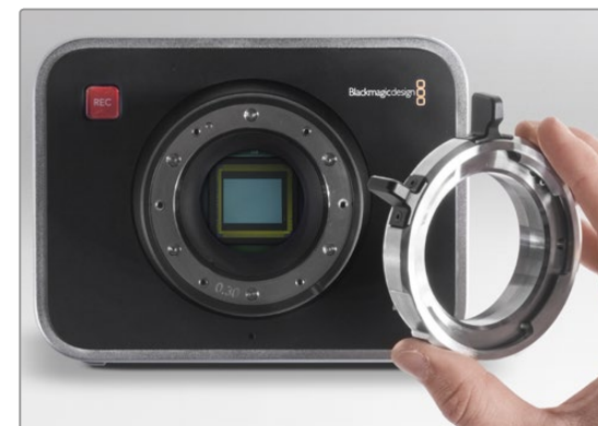
ステップ 6. カメラ筐体にレンズマウントを取り付け、アライメントホールとアライメントピンを11時の位置で揃えます。
