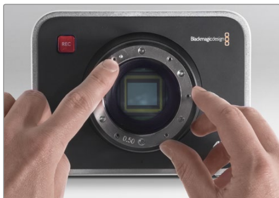
ステップ 4. 装着されている0.50mmシムは、11時の位置にアライメントピンがあります。
