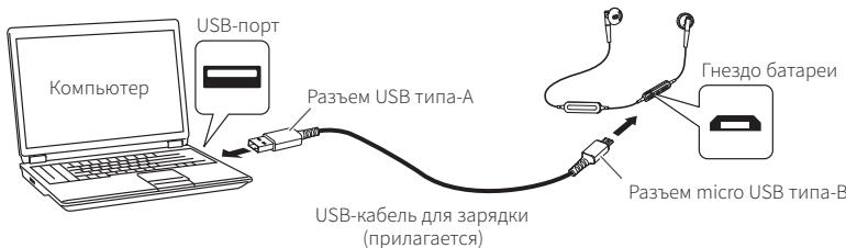
3. Подсоедините прилагаемый USB-кабель для зарядки (разъем USB типа-A) к компьютеру, чтобы начать зарядку.
