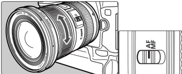
Для съемки в режиме автоматической фокусировки (AF) установите переключатель режимов фокусировки в положение AF. Чтобы использовать ручную фокусировку (MF), установите переключатель режимов фокусировки в положение MF и настройте фокусировку, поворачивая фокусирующее кольцо. Фокусирующее кольцо функционирует всегда, независимо от установленного режима фокусировки.
