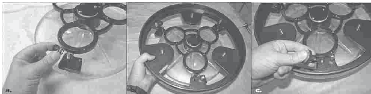
Рис 2. (а) Установите пружины на три винта оправы главного зеркала (б) Опустите торцевое кольцо на оправу главного зеркала так, что винты с резьбой прошли через отверстия в корпусе торцевого кольца, и торцевое кольцо опиралось на пружины. (с) Накрутите гайки с нейлоновыми шайбами на юстировочные винты, проходящие через отверстия в торцевом кольце. Проверьте, чтобы гайки на юстировочных винтах были закручены не менее чем на три полных оборота.
