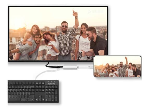
**3** На внешнем дисплее настройте в качестве источника сигнала вход HDMI, DP или MiniDP.
