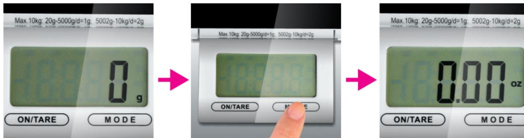
6. Установите продукт для взвешивания на платформу весов. На ЖК-дисплее будет отображен вес продукта.
