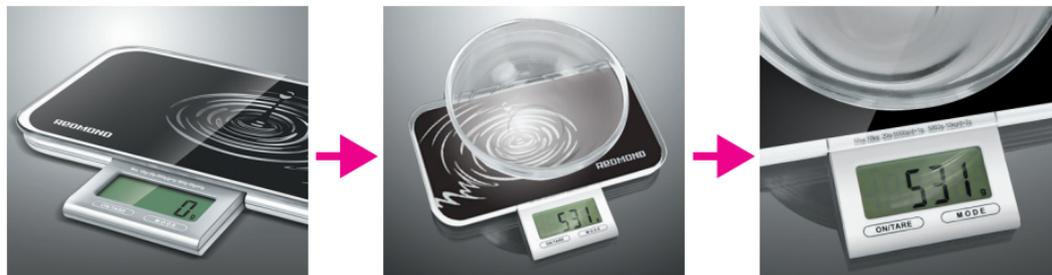
8. После установки емкости и отражения ее веса на ЖК-дисплее, нажмите кнопку **ON/TARE**. Это позволит не учитывать вес тары, на весах отобразится «0». Положите продукт в емкость, на дисплее отобразится только масса продукта, т.к. масса тары не учитывается
