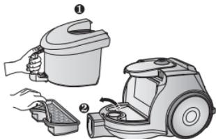
Зніміть пилозбірник та та вийміть касету предмоторного фільтра як показано на малюнку.
