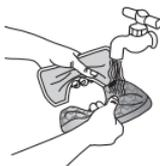
Промийте пористу прокладку і фільтр водою.
