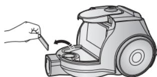
Извлеките фильтр защищающий электродвигатель из пылесоса. Вытряхните и выбейте пыль из фильтра и вставьте его обратно в пылесос.
