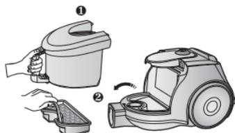
Вийміть пилозбірник і касету предмоторного фільтра.
