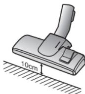
Если интенсивность всасывания заметно падает когда входное отверстие расположено на расстоянии 10 см над полом, его следует прочистить.
