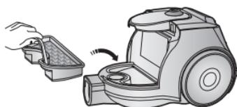
Помістіть зібрану касету предмоторного фільтра у корпус пилососа.
