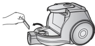
Вийміть фільтр захисту двигуна із пирососа. Витрусіть пил із фільтра та встановіть його назад у пиросос.
