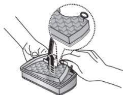
Вийміть губку та фільтр з корпусного фільтра для пилу.
