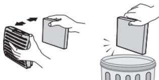
Снять и заменить засоренный выходной фильтр.
