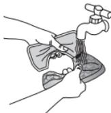
Промойте в воде губчатый элемент и корпус воздушного фильтра пылевого блока.
