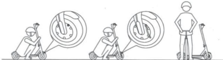
Если шина вышла из строя, снимите заглушку на нипеле и подсоедините его к воздушному насосу для подкачки.
