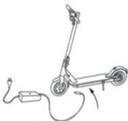
Перед первым использованием самоката полностью зарядите аккумулятор. Откройте резиновую крышку зарядного порта в нижней части самоката и вставьте выходной разъем зарядного устройства в зарядный порт. Вставьте вилку в розетку. Если индикатор зарядного устройства красный, это означает, что аккумулятор заряжается. Если он становится зеленым, это означает, что аккумулятор полностью заряжен.
