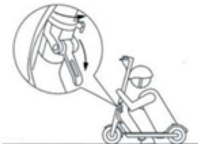
Нажмите на фиксатор на заднем крыле, чтобы освободить руль
