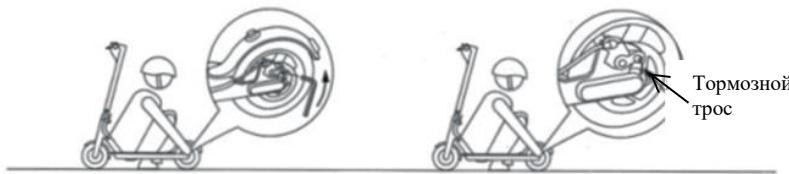
Если вы чувствуете, что тормоз слишком туго затянут, используйте шестигранный ключ M5 против часовой стрелки, чтобы ослабить винт на дисковом тормозе, отрегулируйте тормозной трос, чтобы его длина стала немного короче, и затяните винт. Если вы чувствуете, что тормоз слишком ослаблен, ослабьте винт, отрегулируйте тормозной трос, чтобы его длина стала немного длиннее, а затем затяните винт.
