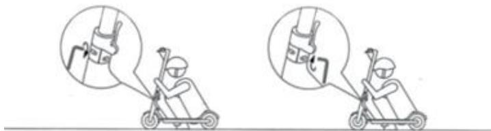
Если стойка зафиксирована ненадежно, затяните шестигранным ключом два винта на механизме складывания.
