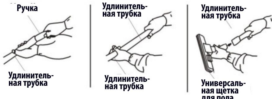
2. Соедините гибкий шланг и удлинительную трубку. Соедините две удлинительные трубы. Подсоедините универсальную щетку для уборки пола или ковра. Чтобы снять одну насадку и установить другую, просто потяните.
