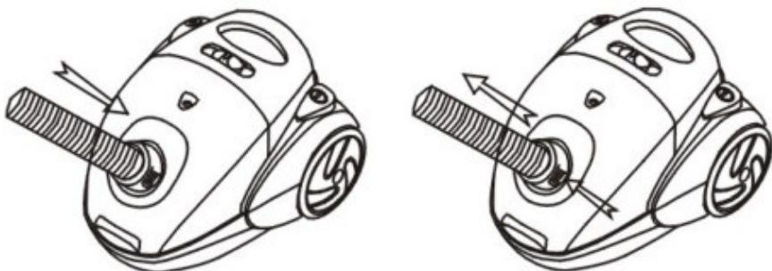
1. Вставьте гибкий шланг переходником в соответствующее отверстие в пылесосе и нажмите до фиксации. Чтобы отсоединить гибкий шланг, до конца нажмите кнопку на основании шланга и снимите шланг.
